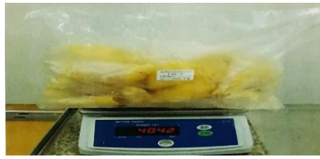
(2) นำทุเรียนแช่แข็งมาบรรจุในถุงลามิเนท ขนาด 400x430 มม. น้ำหนักสุทธิในการบรรจุ ทุเรียนแบบพวกเพิ่มถุง ไม่ต่ำกว่า 4,040 กรัม/ถุง
