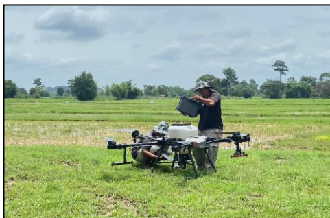
ภาพการใช้โดรนทางการเกษตรในการหว่านปุ๋ยเคมี ในแปลงข้าว จังหวัดสกลนคร
